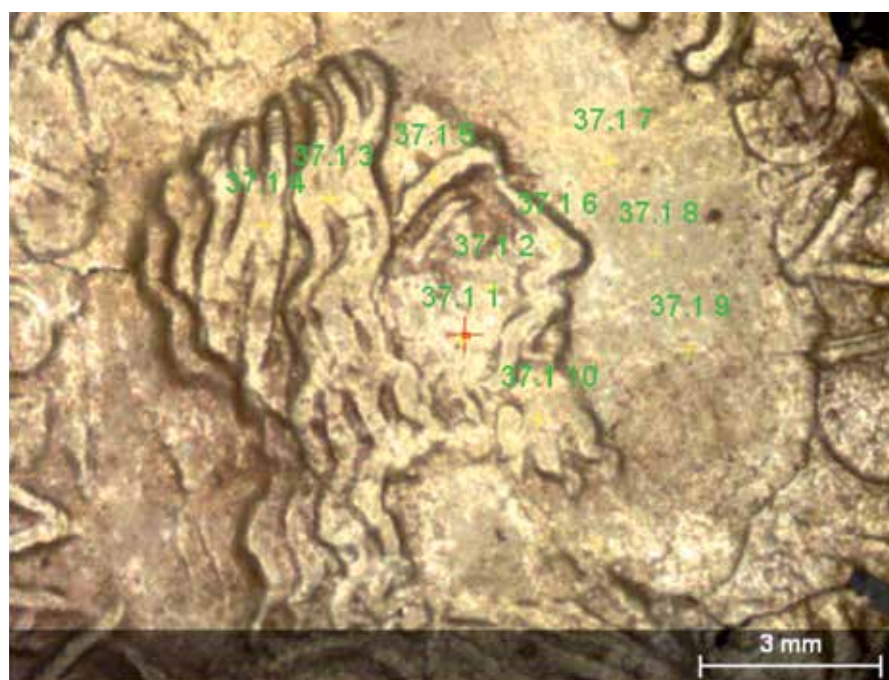
Рис. 12. Пример точечного анализа статера Савромата II (погр. 250, гроб 1) по методу РФА на спектрометре M4 Tornado (Bruker)
