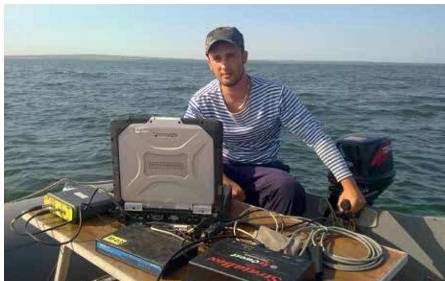
Рис. 14. Исследование структуры донных отложений профилографом StrataBox, 2012 г.
