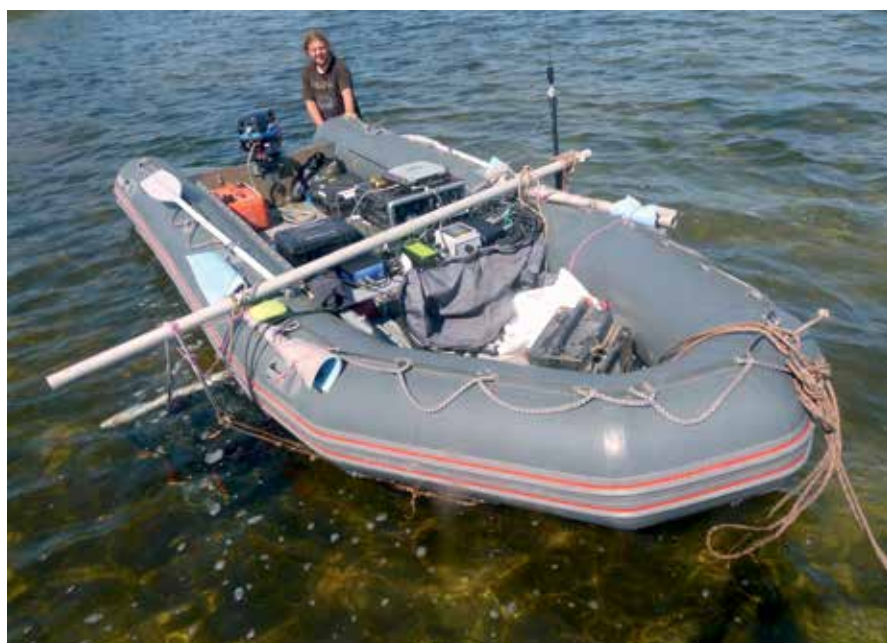
Рис. 24. Исследование структуры донных отложений профилографом Bathy, 2014 г.
