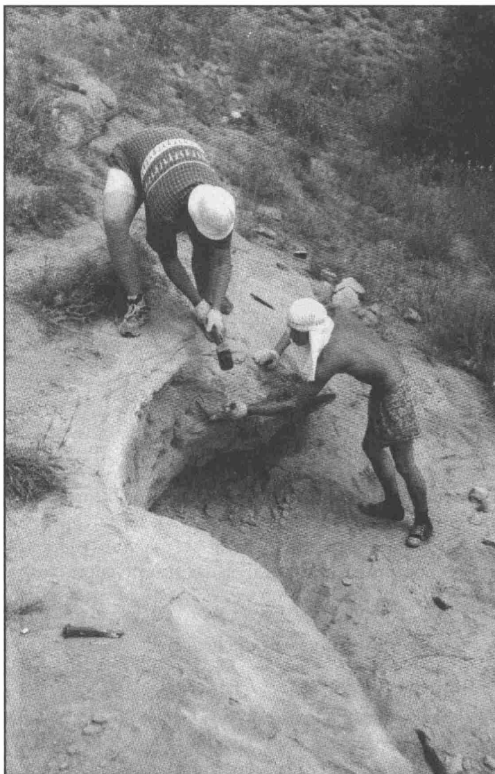
Рис. 9.12. Эксперимент по горной поверхностной проходке в песчаниковой породе: работа ведется с помощью железных орудий
