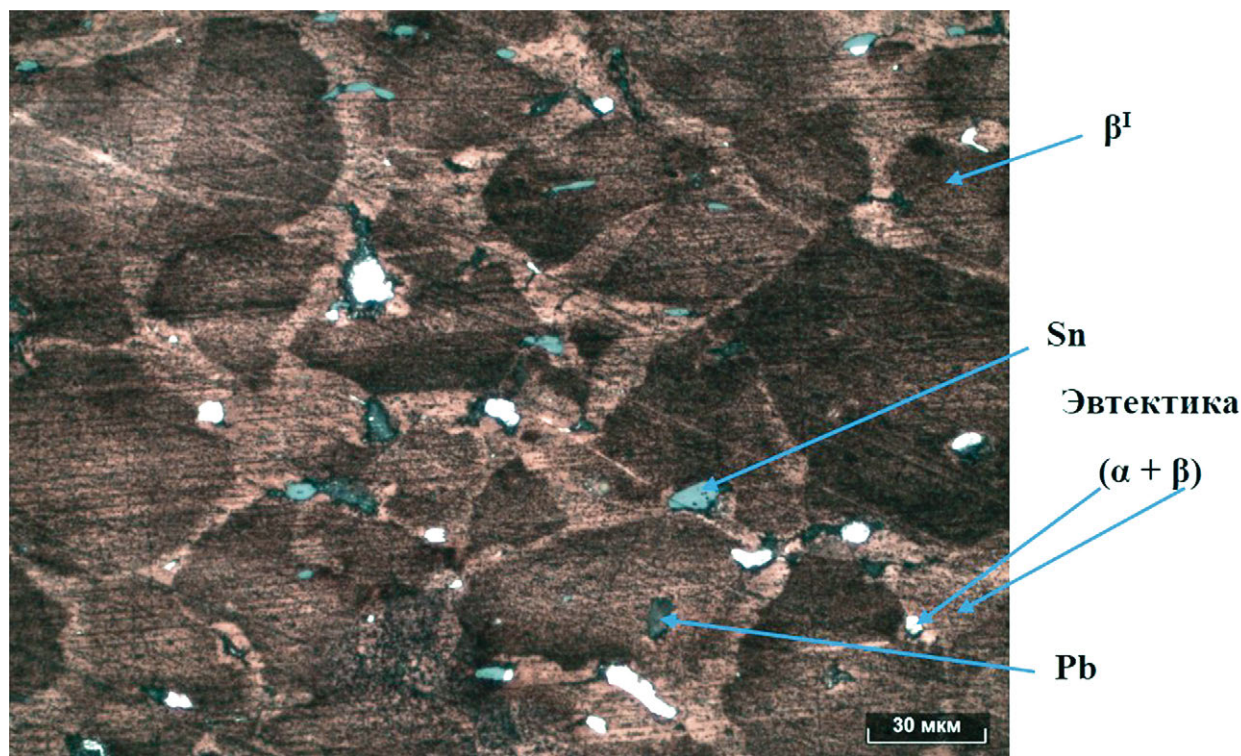
Рис. 100. Микроструктура поперечного шлифа, изготовленного с гурта статера Фофорса № 2398.
