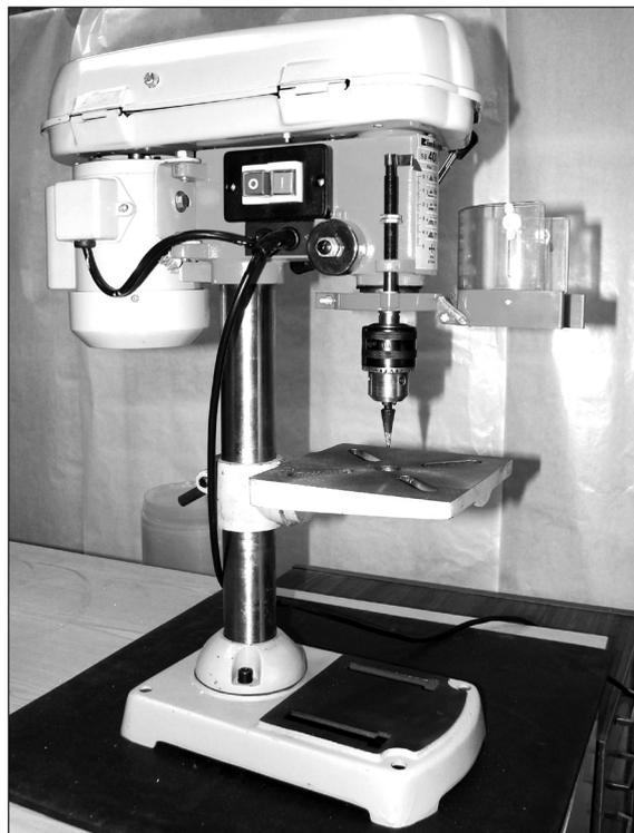
Рис. 5. Стационарный станок для отбора проб
