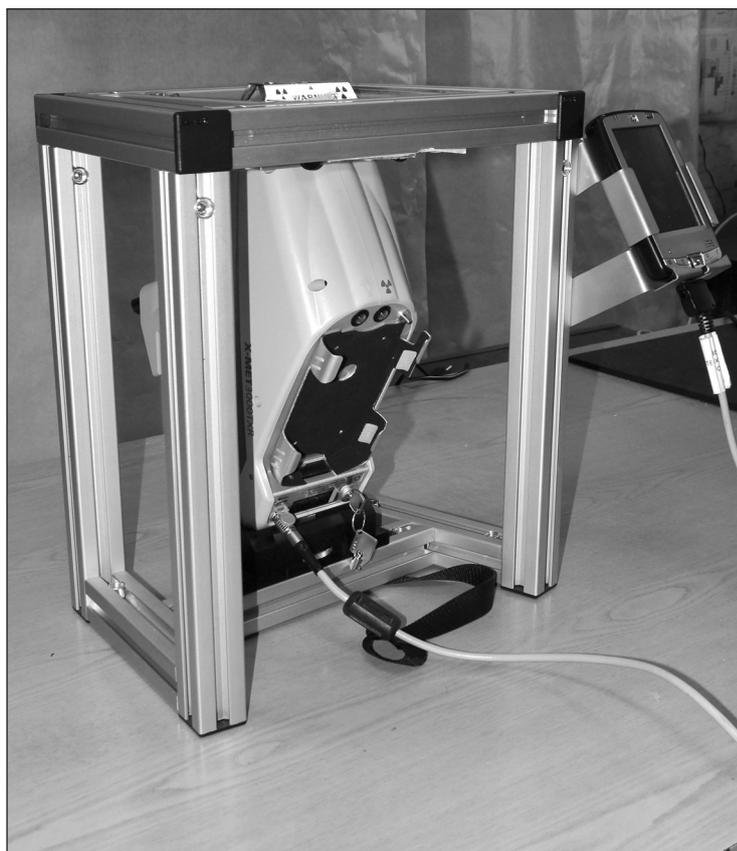
**Рис. 1.** Внешний вид анализатора элементарного состава X-MET3000TXR, закрепленного на штативе
