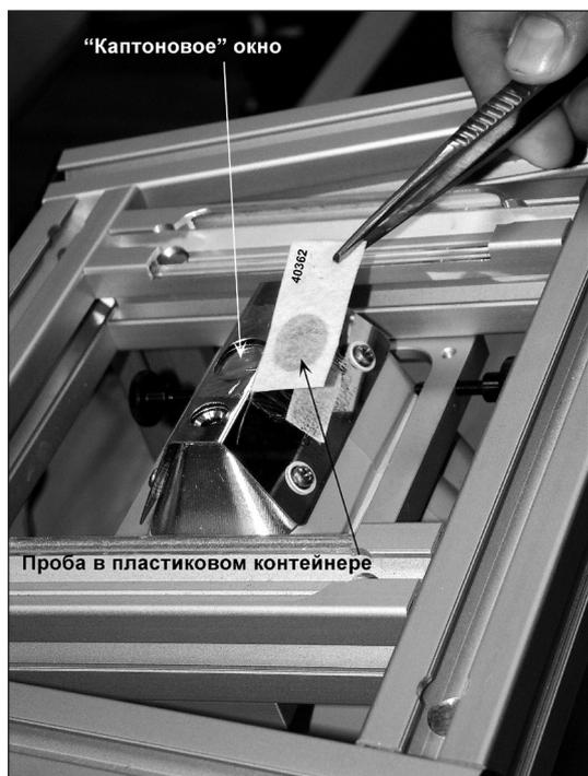
Рис. 4. Подготовленный образец у измерительного окна прибора
