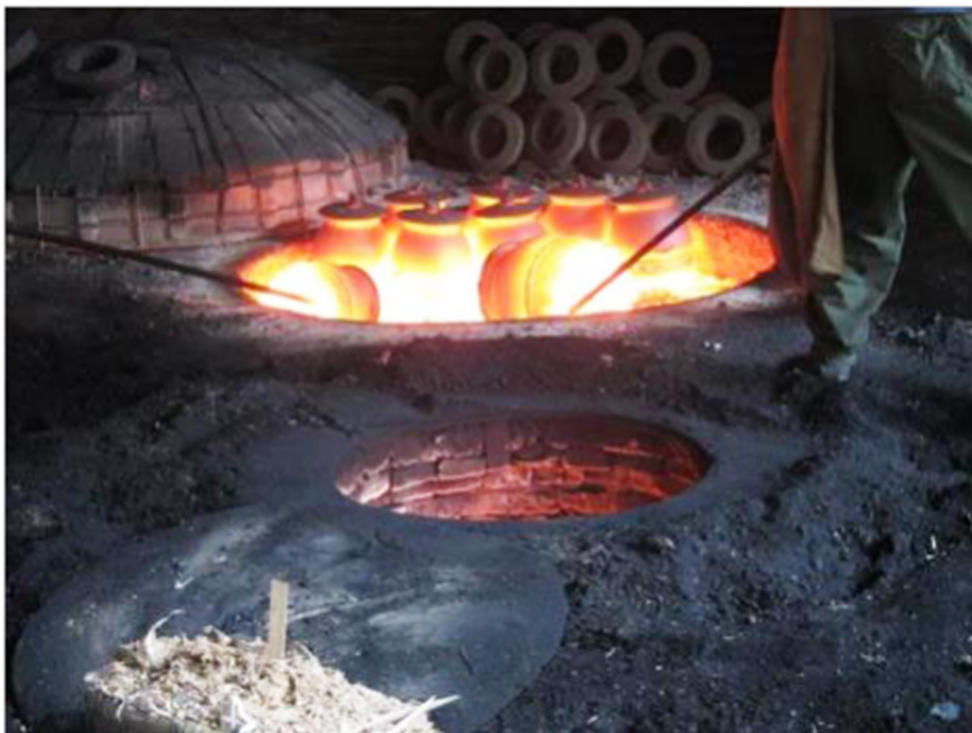
Рис. 5. Процесс обжига в Инцизине. На заднем плане – яма для первичного обжига; купол (слева) снят для перемещения обожженных изделий во вторую яму (на первом плане) для термообработки в восстановительной среде (Фото из статьи: Reedy, Vandiver, 2017. Fig.24)
