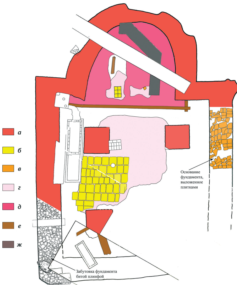
• Илл. 4. План малого храма по раскопкам Б. А. Рыбакова (сведен автором из двух планов: Рыбаков, Николаева, 1968. Л. 3, 4), расцветка автора: а — фундаменты малого храма; б — отпечатки плиток пола малого храма; в — открытые in situ плитки; г — известковая заливка пола малого храма; д — заливка пола деревянного храма; е — открытые in situ части стен деревянных построек; ж — остатки фундамента поздней деревянной церкви, разрушенной в 1941 г.
