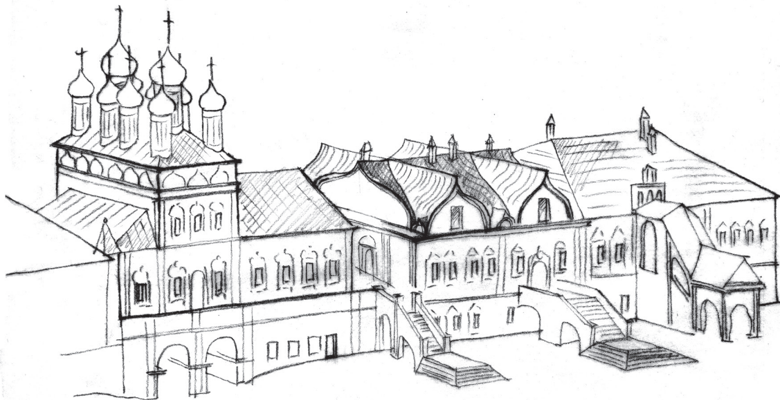
• Илл. 11. Эскизная реконструкция западной части здания с крещатой бочкой, выходящей на боковые фасады. Рисунок Е. Н. Пророковой
