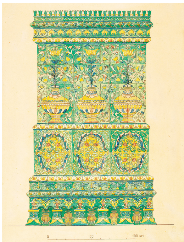
• Илл. 2. Ю. П. Спегальский. Реконструкция печи кабинета хозяина в доме Печенко в Пскове. 1955–1956 гг.
