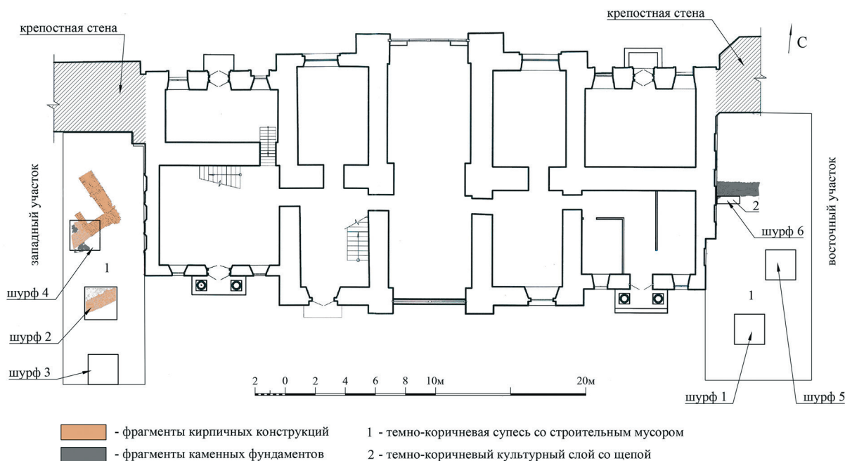
• Илл. 7. Смоленск. Церковь Одитритии. План с открытыми конструкциями и фундаментами, 2021–2022 гг.
