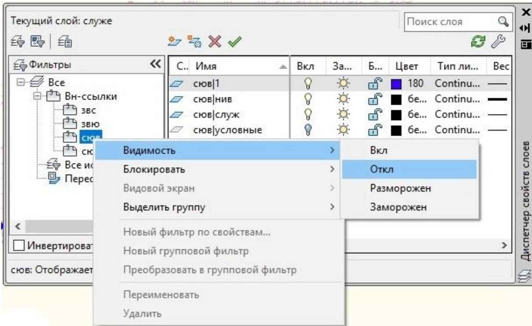
«Диспетчер свойств слоев». В его левом, озаглавленном «Фильтры», представлены все внешние ссылки (Вн-ссылки), вставленные в данный электронный документ чертежи профилей «ЗВС», «ЗВЮ», «СЮЗ», «СЮВ».
