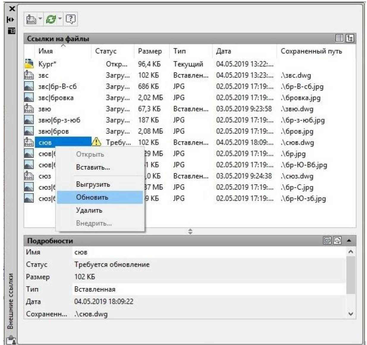
**Панель «Внешние ссылки...». Позволяет обновить 3-d модель после редактирования**
