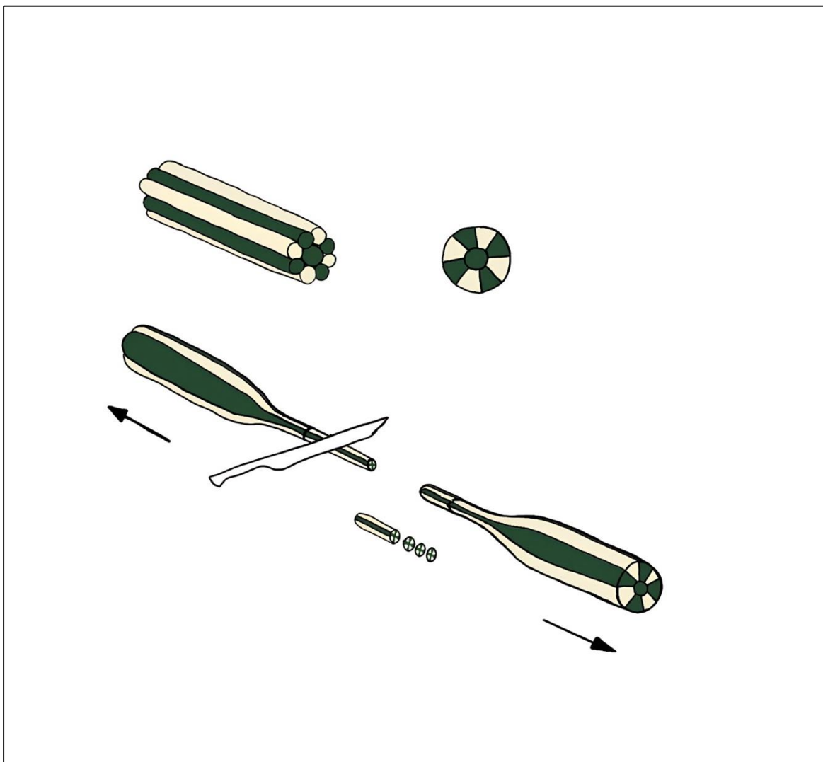
Рисунок В.10 – Изготовление полихромной палочки путем соединения нескольких стеклянных прутиков
