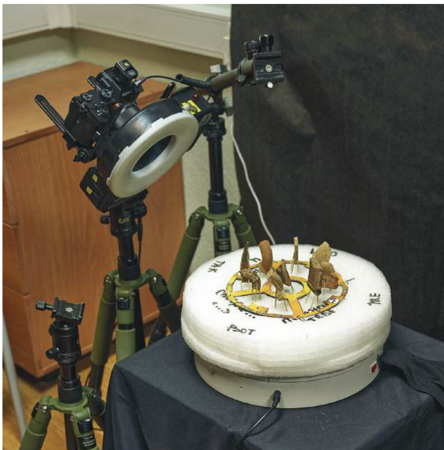
Рис. 3. Установка для фотограмметрического документирования небольших предметов револьверным способом.
