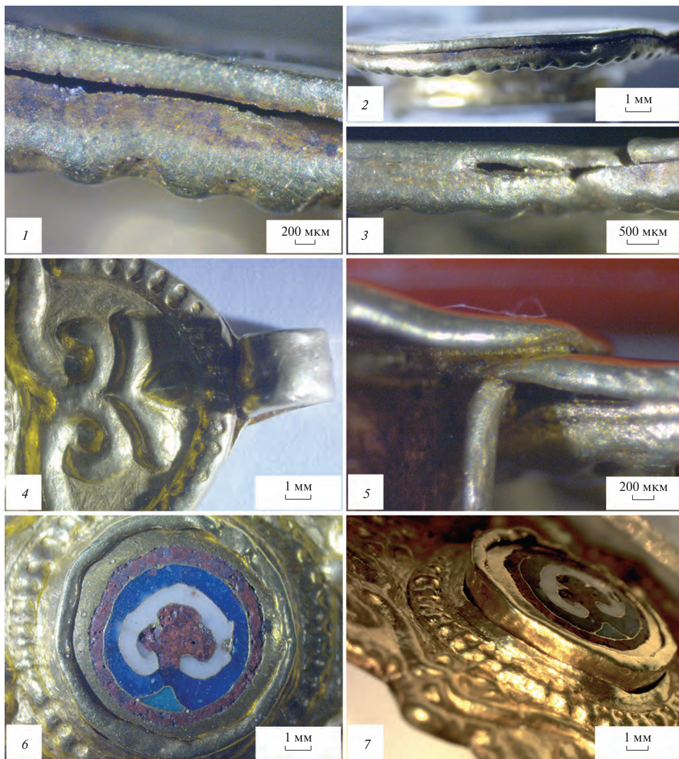
Рис. 4. Детали подвески. 1, 2 — зазор между пластинами, 3 — погрешности пайки, 4 — тисненая пластина (лицевая створка), 5 — ушко, 6, 7 — центральная вставка.
