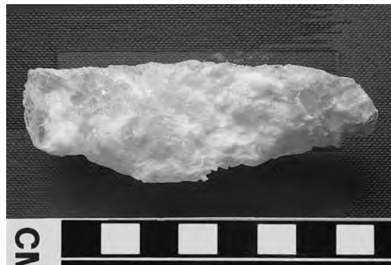
Рис. 1. Скол гипсовой плиты, на котором видна мелкозернистая алебастровая масса и розетковидные включения крупных кристаллов гипса.
