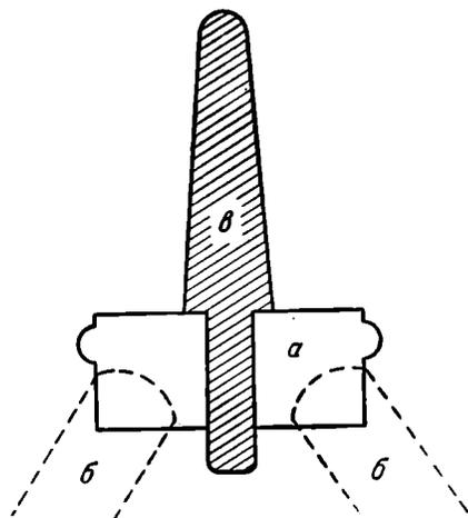
Рис. 43. Приспособление для установки буссоли на штатив фотоаппарата
