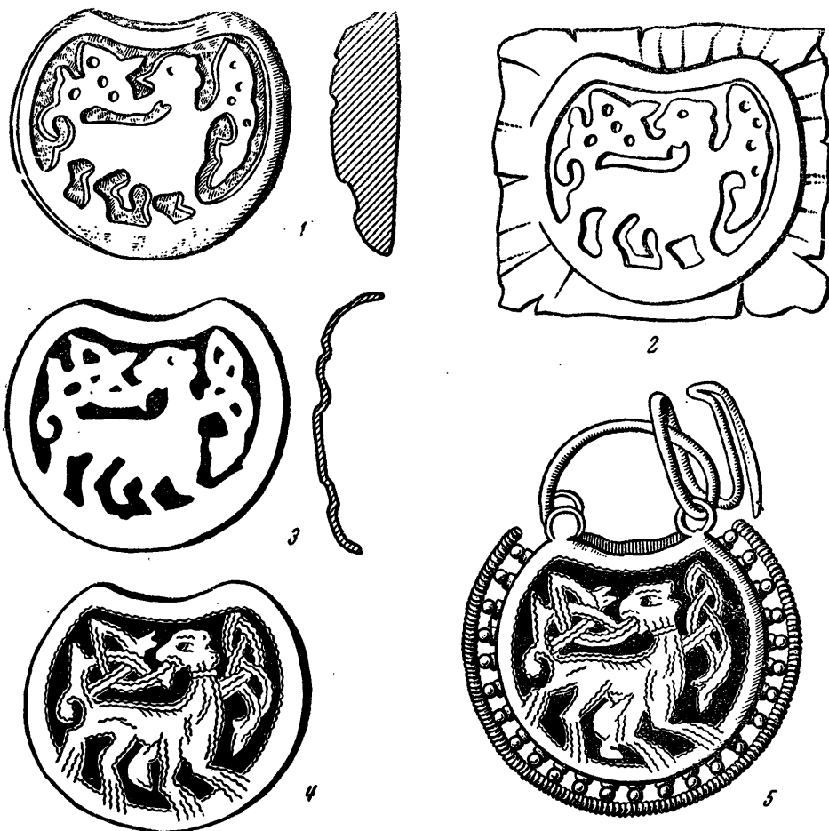
Рис. 84. Процесс изготовления серебряных колтов с чернью: 1 — медная матрица для штампования серебряных листов; 2 — тиснение серебряного листа на матрице; 3 — заливка углублений чернью и обжиг черни; 4 — зачистка черни и разделка контуров резцом; 5 — два щитка, спаянных вместе; по рёбру напаяны шарики и проволока, приделаны петли и дужка (Святозерский клад, близ Черпигова).
