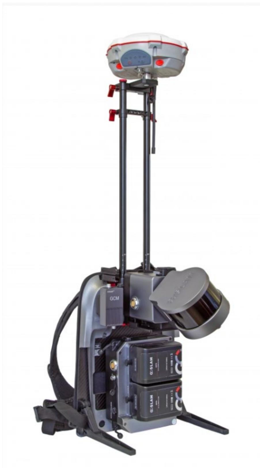
Мобильный лазерный 3D сканер **GoSLAM RS100S** относится к классу ручных сканеров, в которых используется SLAM технология – позиционирование в режиме реального времени, где отсутствует GNSS позиционирование. При перемещении в пространстве, будь то внутренние помещения или открытые территории, сканер сам понимает где он находится за счет окружающих его объектов и одновременно эти объекты сканирует.
