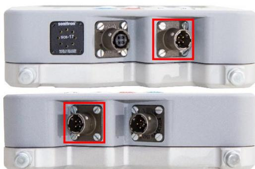
*Рисунок 35 Разъемы CAN FD+12V для подключения кабеля датчик-пульт на корпусе ПУ*
