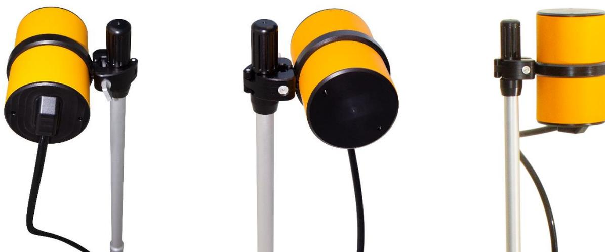
Рисунок 80 Оверхаузеровский датчик, закреплённый на немагнитной треноге
