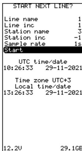
Рисунок 54 Окно меню запуска съёмки на следующем профиле
