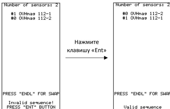
Рисунок 67 Окно списка датчиков градиентометра
