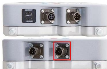
Рисунок 112 Разъем для подключения кабеля USB на корпусе ПУ MaxiMag
