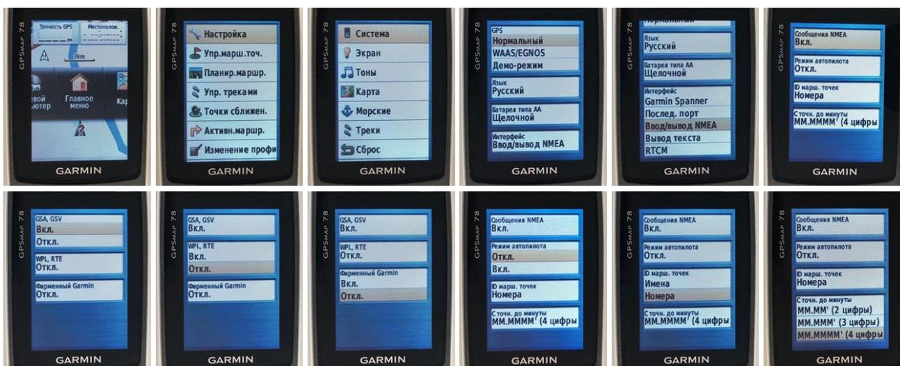
Рисунок 27 Установка настроек интерфейса связи навигатора Garmin GPSMAP 78
