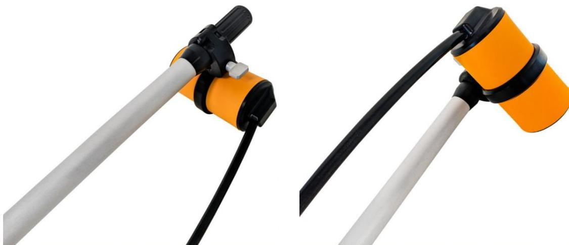
*Рисунок 14 Оверхаузеровский датчик, закреплённый на штанге*
