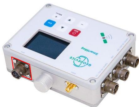
Рисунок 81 Разъём для подключения кабеля Оверхаузеровского датчика на корпусе ПУ
