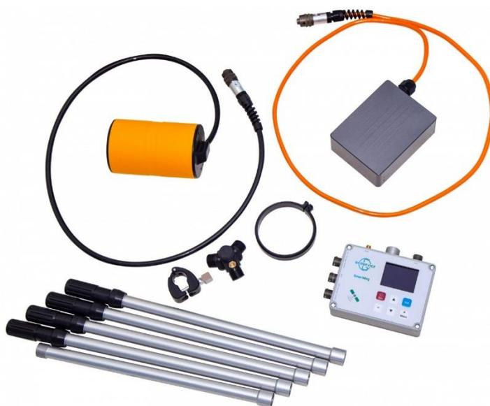
*Рисунок 76 Состав пешеходного оверхаузеровского магнитометра SmartMag*
