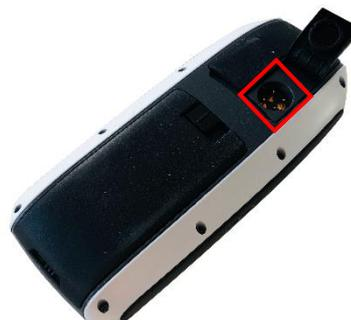
Рисунок 26 Разъём для подключения связи на корпусе Garmin GPSMAP 78
