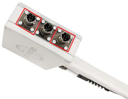
Рисунок 18 Разъёмы для подключения аккумулятора на корпусе блока электроники
