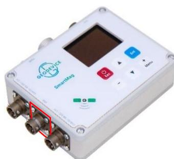
Рисунок 113 Разъем для подключения кабеля USB на корпусе ПУ на корпусе магнитометра SmartMag
