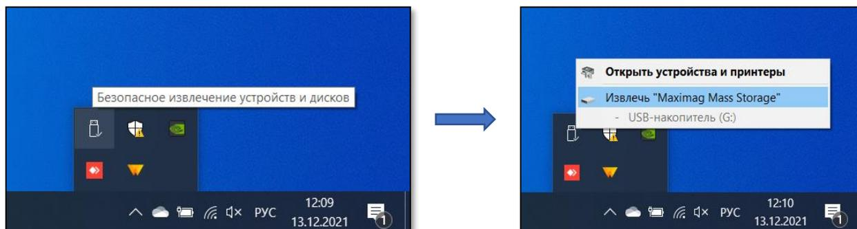
*Рисунок 138 Безопасное отключение пульта MaxiMag от ПК*
