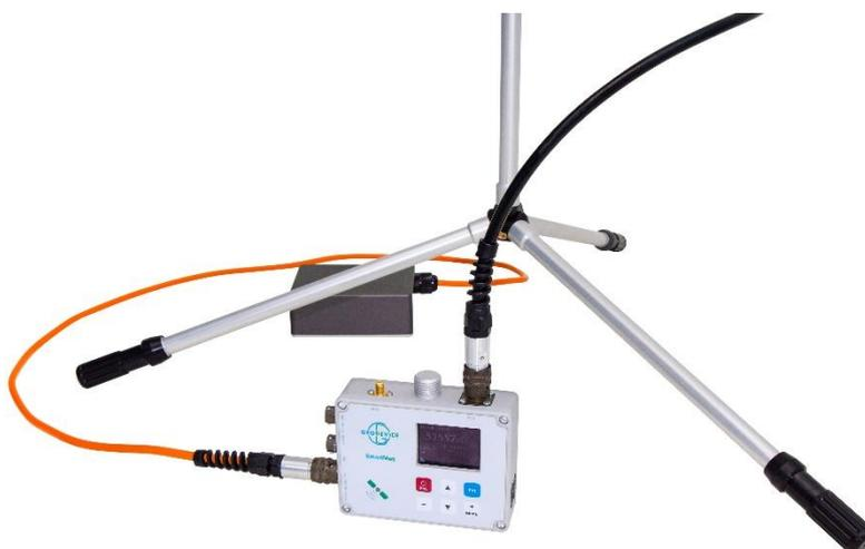
Рисунок 85 ПУ с подключенным Оверхаузеровским датчиком и аккумулятором
