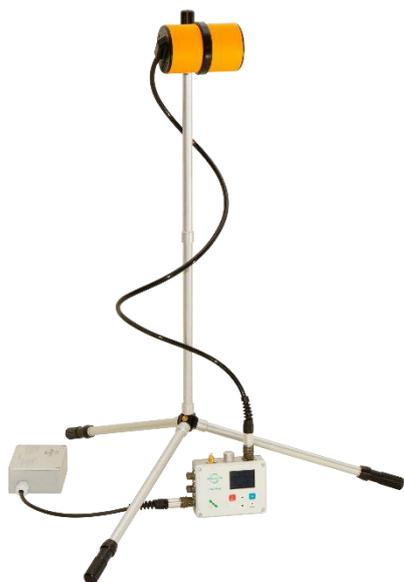
*Рисунок 39 Горизонтальная ориентация датчик на кабеле*
