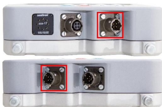
Рисунок 30 Разъёмы CAN FD+12V для подключения кабеля датчик-пульт на корпусе ПУ
